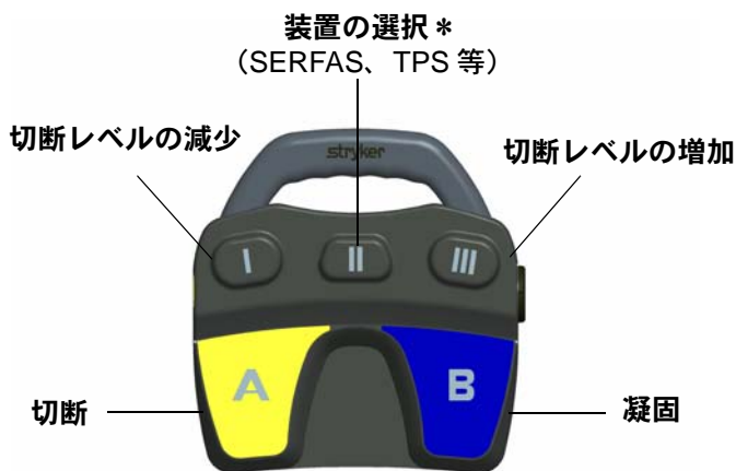
図 6: SERFAS モードでのワイヤレスフットスイッチの初期設定コントロール
