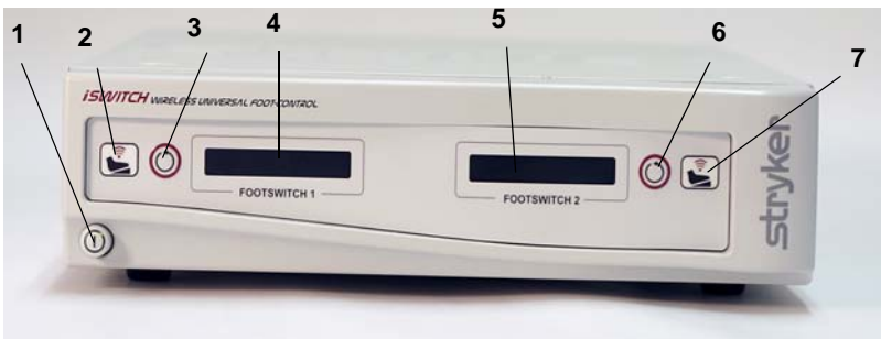
Afbeelding 2: Voorpaneel van de ontvanger
