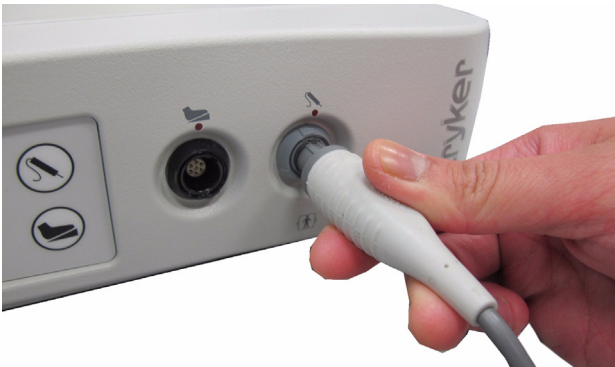
Abbildung 4: Anschließen der Sonde an den Generator
