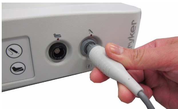
Figur 4: Å kople sonden til generatoren
