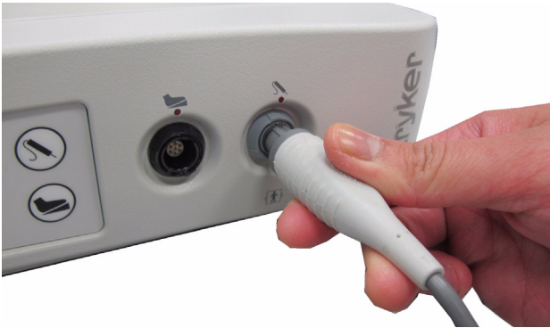
Kuva 4: Koettimen liittäminen generaattoriin
