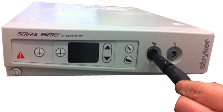
図 5： フットスイッチとジェネレーターの接続
