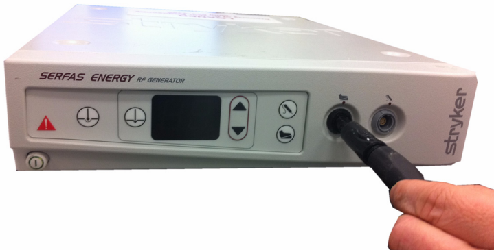
Afbeelding 5: De voetschakelaar op de generator aansluiten
