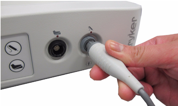
Figur 4: Ansluta sonden till generatoren
