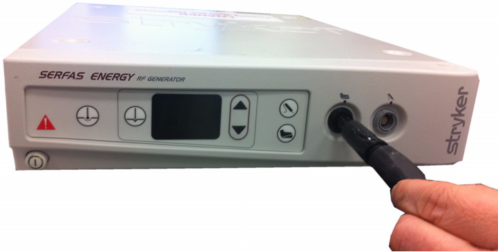
Εικόνα 5: Σύνδεση του ποδοδιακόπτη στη γεννήτρια
