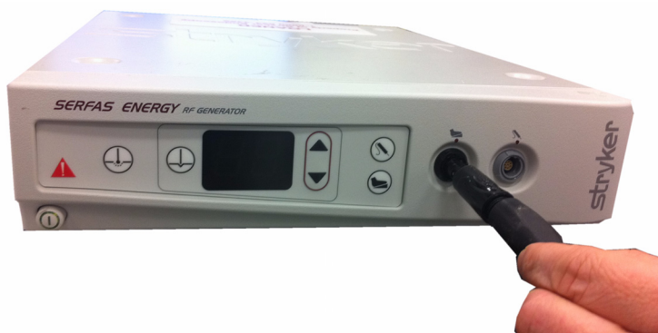
Figura 5: Ligação do Interruptor de Pé ao Gerador
