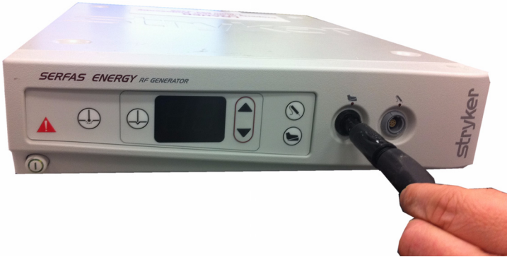
Kuva 5: Jalkakytkimen liittäminen generaattoriin
