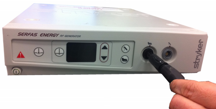
Figura 5: Conexión del interruptor de pedal al generador
