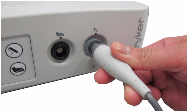
Figura 4: Ligação da Sonda ao Gerador
