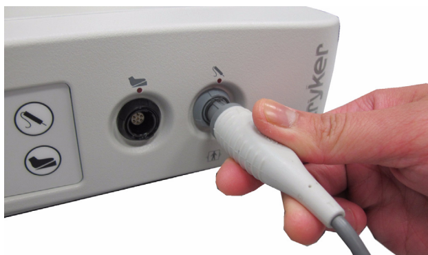
Εικόνα 4: Σύνδεση της μήλης στη γεννήτρια
