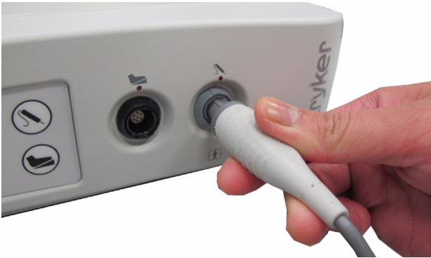
Afbeelding 4: De probe op de generator aansluiten
