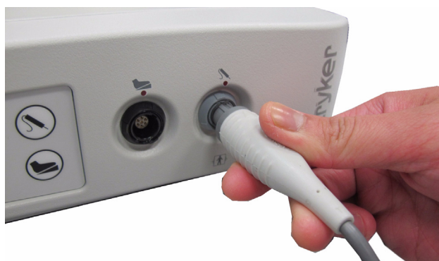
図 4: プローブとジェネレータの接続
