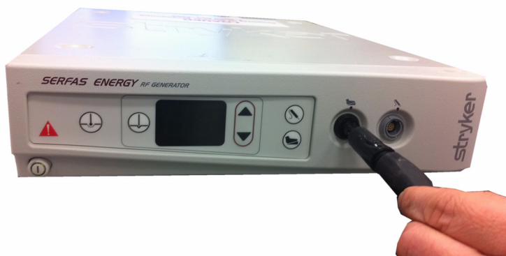
Rysunek 5: Podłączenie przełącznika nożnego do generatora
