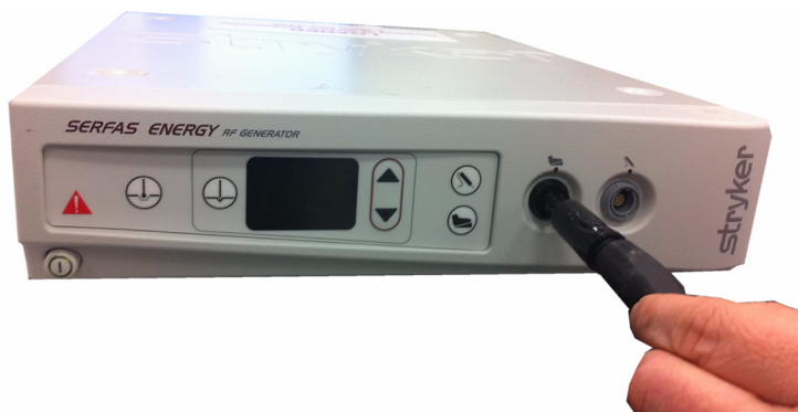
Figure 5 : Connexion de la pédale au générateur
