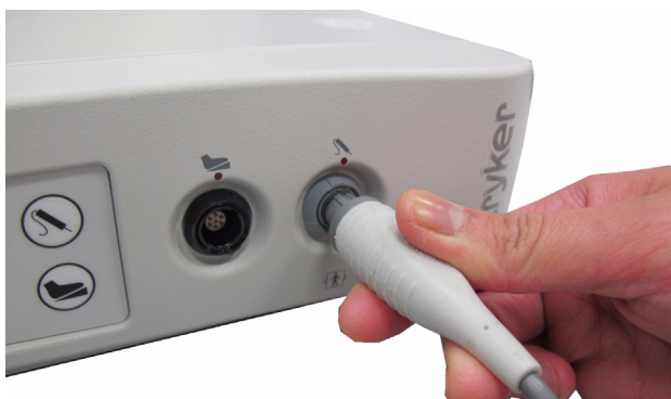
Figure 4 : Connexion de la sonde au générateur
