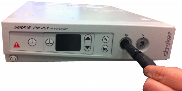
Figur 5: Tilslutning af fodkontakten til generatoren
