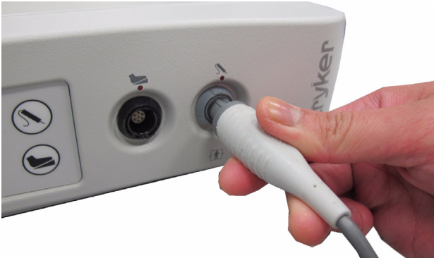
Figura 4: Conexión de la sonda al generador
