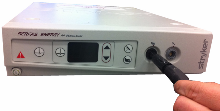
Abbildung 5: Anschließen des Fußschalters an den Generator
