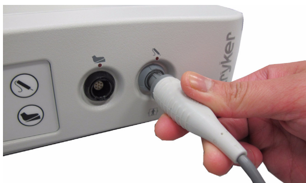
Figur 4: Tilslutning af sonden til generatoren
