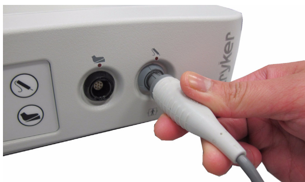
Figura 4: Collegamento della sonda al generatore
