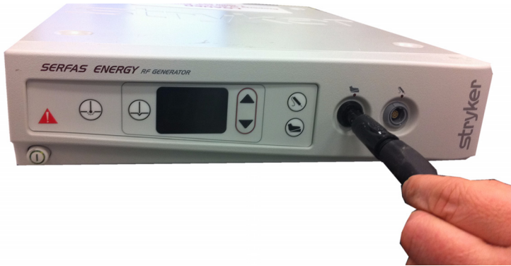
图 5： 将脚踏开关连接到发生器
