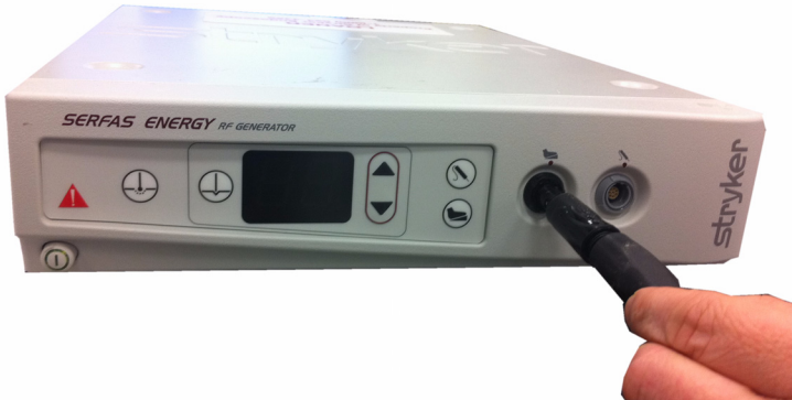
Figur 5: Ansluta fotkontrollen till generatoren
