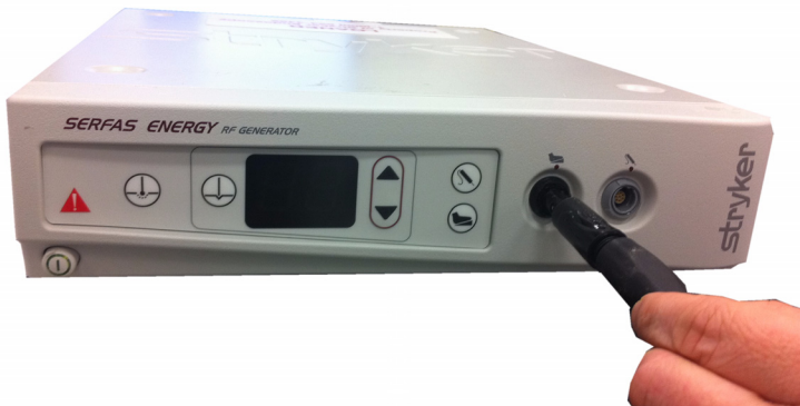
Figur 5: Å koble fotbryteren til generatoren
